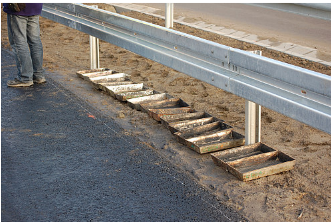
Fot. 4 – Przygotowane do pobrania próbek mieszanki foremki stalowe
